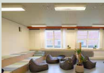
Fællesrum på Hanstholm Skole før (april 2019) og efter (september 2019) installation af nyt LED-lys med separat indstilling af lysintensitet og lysfarve for både uplight og downlight
