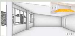
Figur 2. Klasseværelse på Tilsted Skole med træer til at afskærme direkte sol, høje vinduer og lofter der er skrå og reflekterende for dagslyset. Indsat en lysberegning af belysningsforholdene ved grundbelysning (40/40%, 4000K), som giver jævn arbejdsbelysning. Grafik: KHR.
